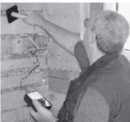
*Das Mobile Prüflabor im Einsatz, Durchführung der Feuchtemessung vor Ort*
