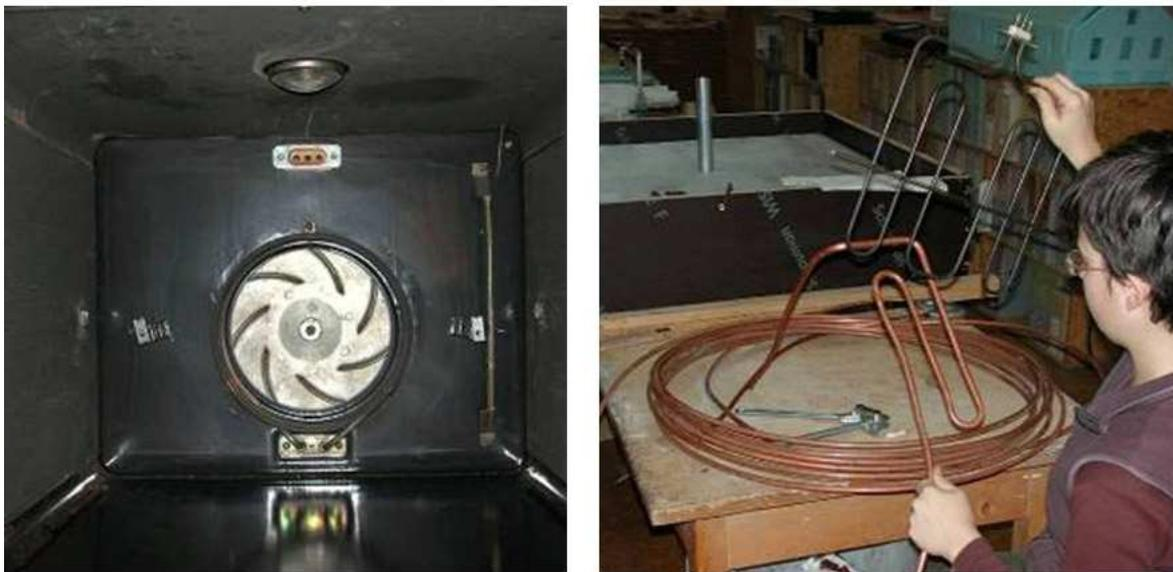
Abbildung 59: Umbau eines elektrisch betriebenen Backrohrs zu einem Thermoölbackofen<sup>79</sup>
