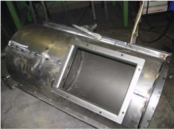
Abbildung 20: Brennkammer mit Türöffnung
