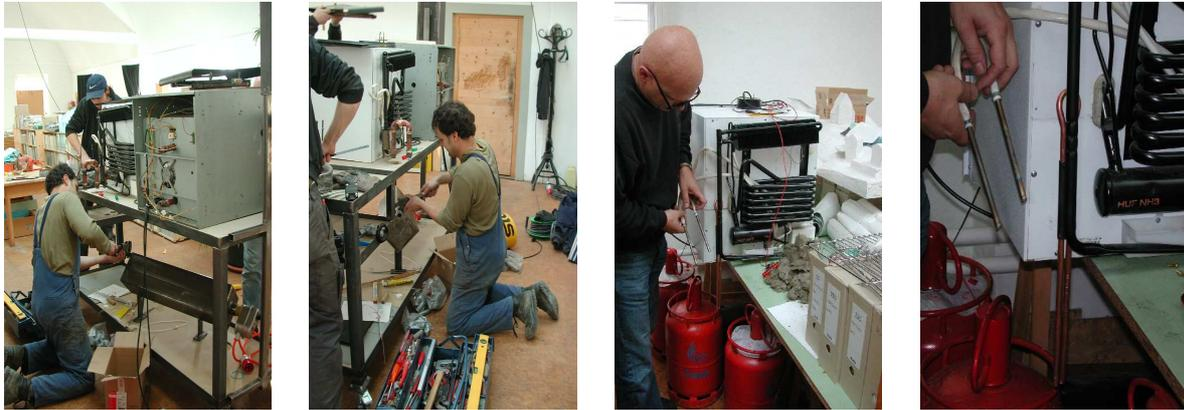
Abbildung 56: Bau des Prototyps der Absorptionskühlmaschine<sup>75</sup>
