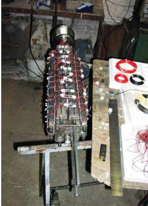
Abbildung 45: Versuchsaufbau mit einem Thermoelektrischen Generator mit einer Leistung von 100 W<sup>58</sup>
