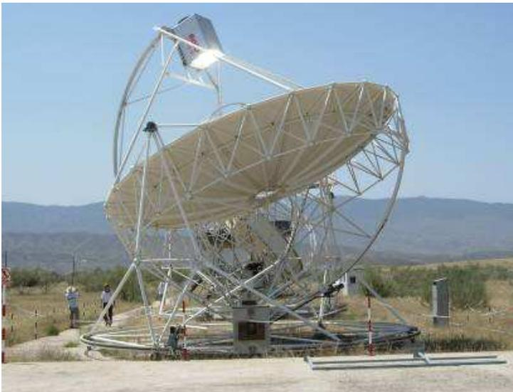
Abbildung 14: System mit mitbewegtem Receiver, der gleichzeitig den Stirlingmotor beinhaltet<sup>25</sup>
