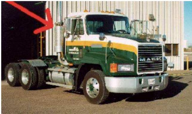
Abbildung 39: TEG mit einer Leistung von 1 kW im Abgasstrom eines 300-PS-LKWs integriert<sup>51</sup>
