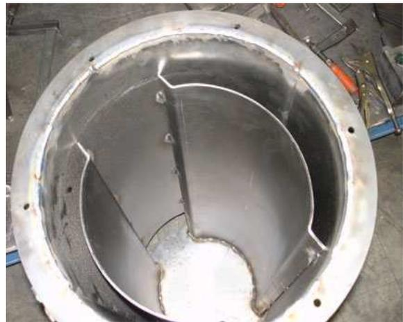
Abbildung 24: Einbau des Abzugrohres
