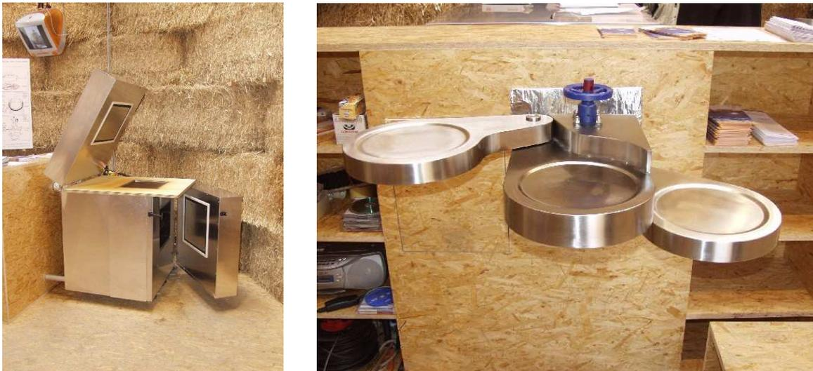
Abbildung 60: Designentwicklungen für einen kombinierten, mit Thermoöl betriebenen Küchenofen und für eine Kochplatte<sup>80</sup>
