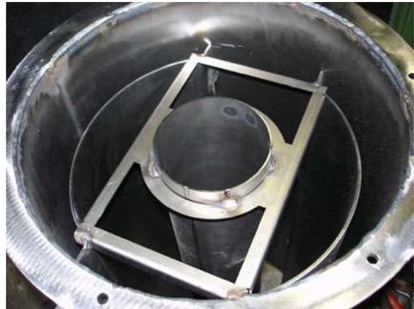
Abbildung 22: Einbau der Züge (Rauchgasführung)
