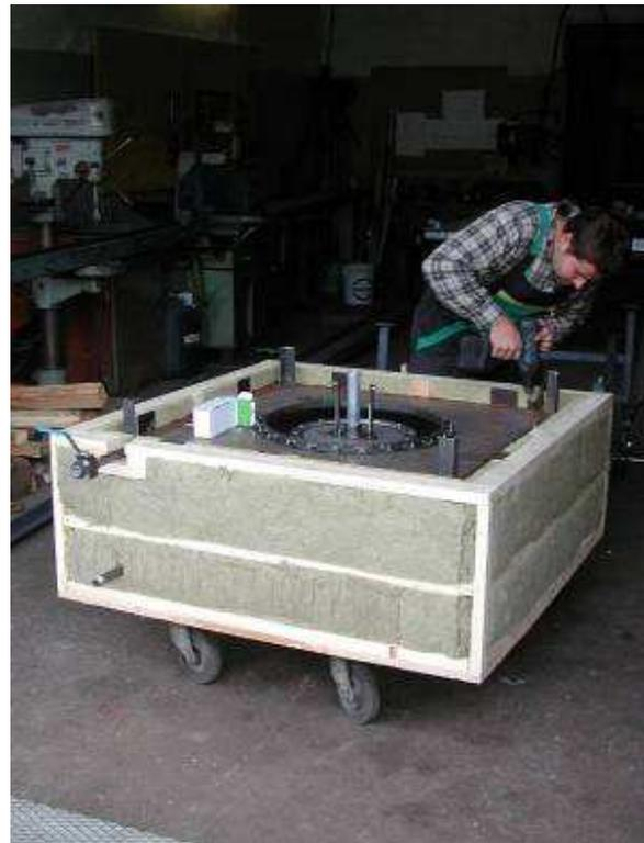
Abbildung 50: Zusammenbau des Stirlingmotor-Prototyps<sup>67</sup>
