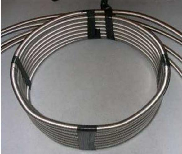
Abbildung 27: Spiralrohr des Wärmetauschers
