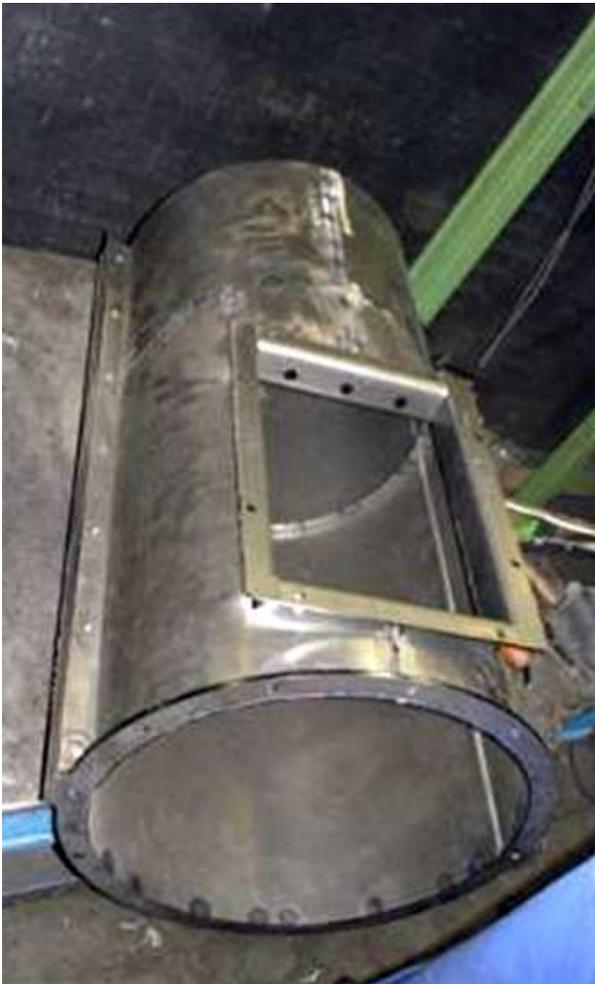
Abbildung 23: Brennkammer, Ansicht von unten
