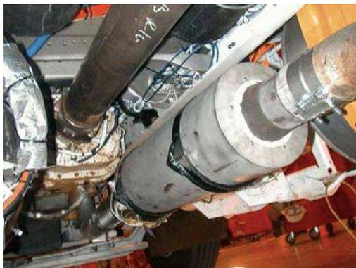
Abbildung 40: TEG, im Auspuff des LKWs installiert<sup>52</sup>
