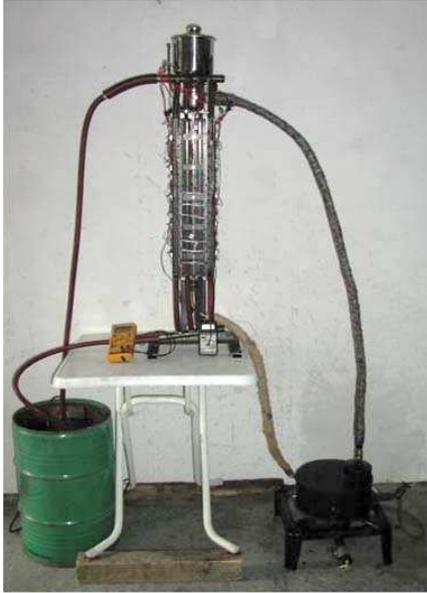
Abbildung 46: Versuchsaufbau Thermoelektrischer Generator, betrieben mit Thermoöl unter Nutzung des Schwerkraftprinzips, Thermoölkreislauf rechts, Kühlwasserkreislauf links<sup>59</sup>
