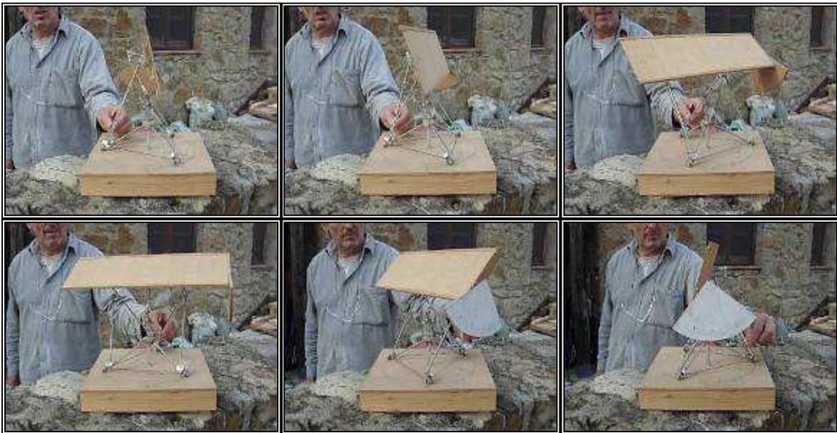
Abbildung 16: Arbeitsweise des Nachführungssystems über den Tagesverlauf (südseitig)<sup>27</sup>
