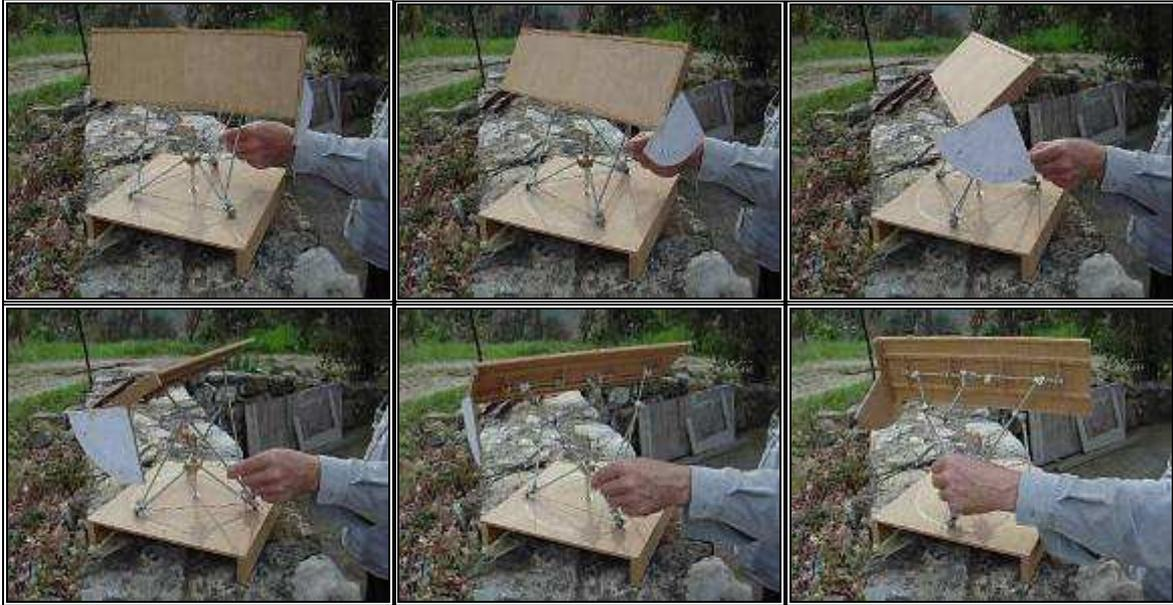
Abbildung 15: Arbeitsweise des Nachführungssystems über den Tagesverlauf<sup>26</sup>
