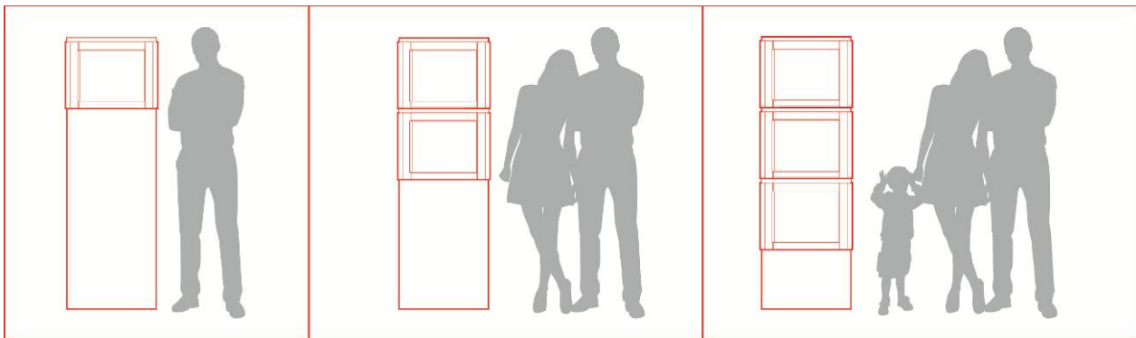
Abbildung 57: Flexible Kapazität des Kühlschranks je nach Nutzeranforderungen
