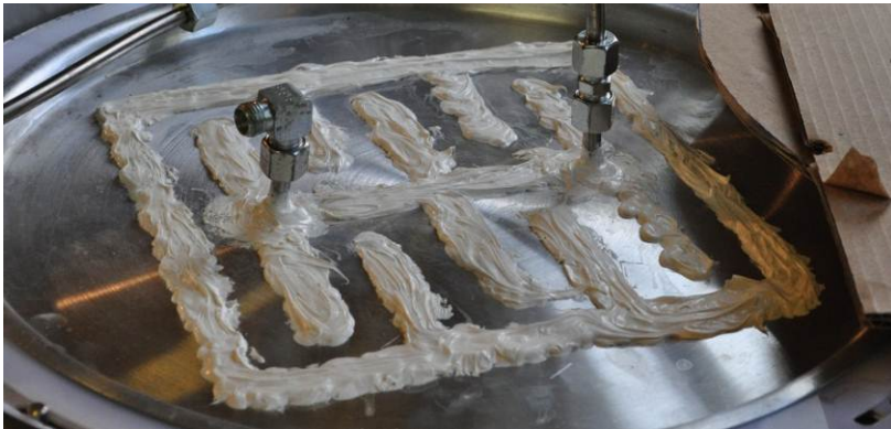
Abbildung 80: Verbindung der Verdampferplatten mit Kleber
