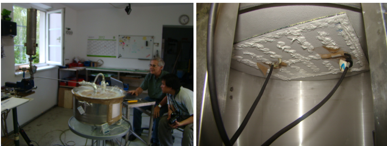
Abbildung 46: Links: Vormuster der von der GrAT entwickelten Kühlkammer; rechts: Der Verdampfer des Vormusters von unten gesehen. Die beiden schwarzen Kabel sind Sensoren zur Messung der Temperatur.
