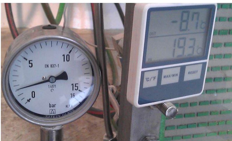
Abbildung 37: Thermometer außen am Icebook. Die obere Zahl zeigt die Temperatur am Verdampfer an, die untere die Raumtemperatur.
