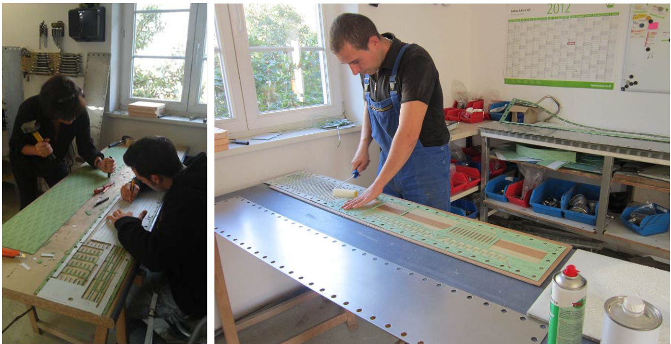
Abbildung 30: Links: Fertigung der Formplatte mit der Hand; rechts: Verkleben der Platten
