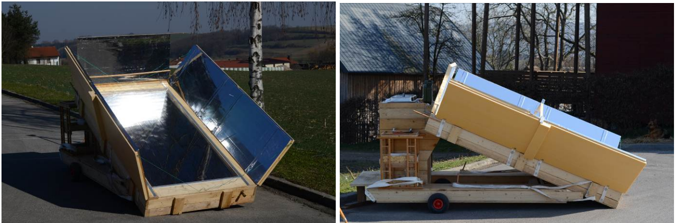
Abbildung 106: Mobiler indirekt betriebener Solarkocher/-cooler (GrAT)
