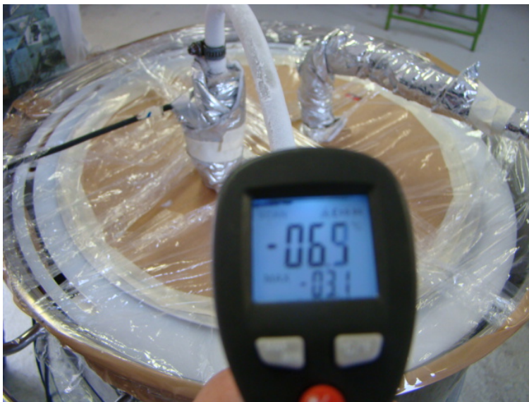
Abbildung 48: Die eingewickelte Kühlkammer beim zweiten Experiment
