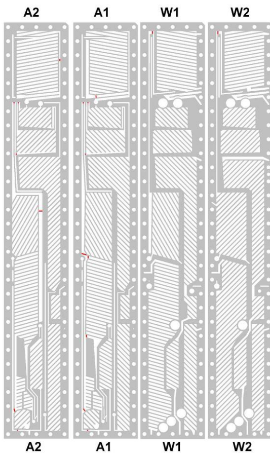
Abbildung 29: Das Mikromodul des 200W-Icebooks ohne Behälter mit Doppelplatten, A1 und A2 ergeben gemeinsam eine doppelte Formplatte für Ammoniaklösung, und W1 und W2 geben gemeinsam eine doppelte Formplatte für die drei Wasserkreisläufe, die die Ammoniakplatte temperieren sollen.
